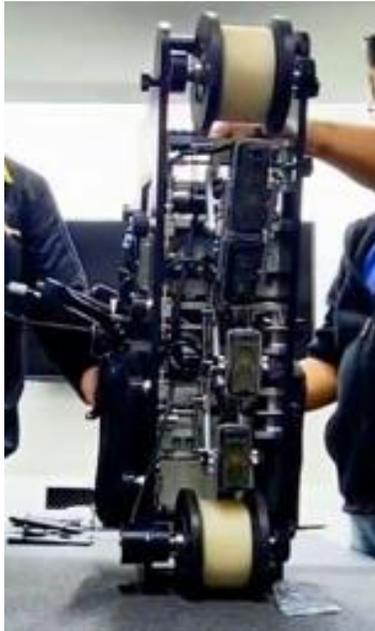
Para incrementar la detectabilidad, el equipo de ultrasonido cuenta con 11 transductores piezoeléctricos que permiten realizar la inspección en 4 ángulos distintos,  $0^\circ$ ,  $45^\circ$ ,  $55^\circ$  y  $70^\circ$  con el fin de evaluar todo el volumen del riel aún cuando la inspección se realiza a altas velocidades.
